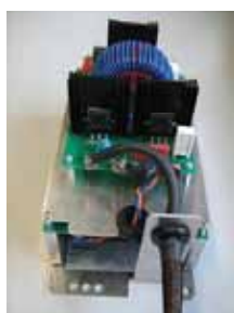
Цифровой генератор плазмы обеспечивает оптимизацию искрового возбуждения
